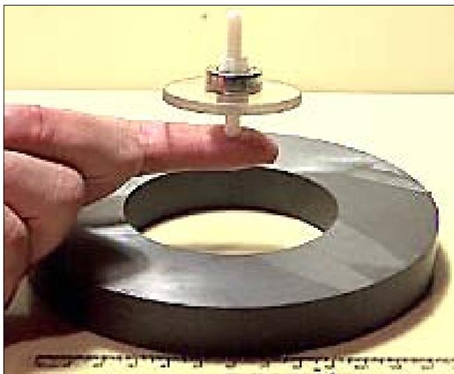
ствии с законом сохранения момента импульса удерживает волчок в положении отталкивающим полюсом вниз. Волчок испытывает силу трения только о воздух, вследствие чего он может парить довольно долго.
