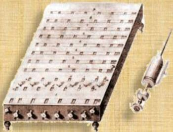
Калькуляторы сейчас стали неотъемлемым атрибутом современной жизни. А вот когда не было калькуляторов, в ходу был **счислитель Куммера**. Сложение и вычитание производилось посредством простейшего передвижения реек.
